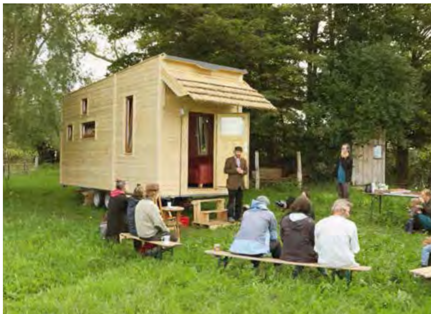
Ein Tiny House aus Moorpflanzen, Reet auf dem Vordach, Rohrkolben zur Dämmung, Erle auf dem Boden
